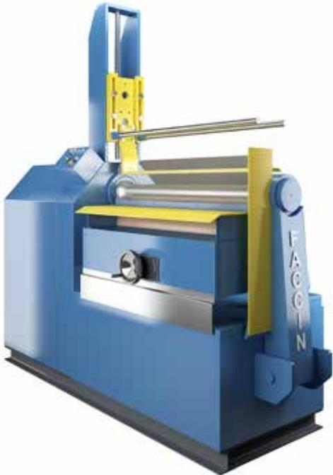
Zweiwalzen Rundbiegemaschine mit Urethanwalze Serie **HCU**
