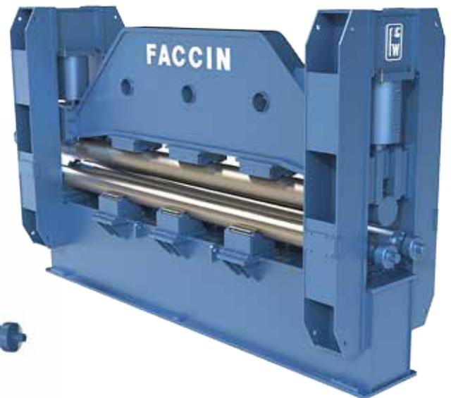
Dreiwalzen Biegepresse für Schiffsbau
